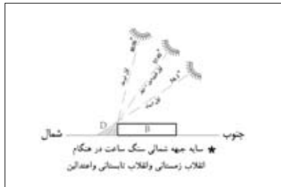
نگاره ۴- سایه جبهه شمالی سنگ ساعت در هنگام انقلاب زمستان و انقلاب تابستانی و اعتدالین. (ماخذ: نگارنده)
